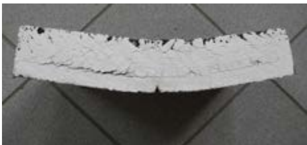
Bewehrter Probekörper ohne ein Durchschlagen von Reflexionsrissen (hier: Faktor 3,8 im Vergleich zum unbewehrten Probekörper)
